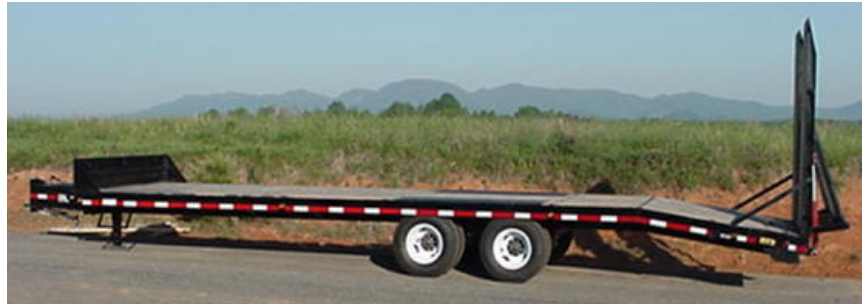
Trailer: 15 Ton Tag Paver
